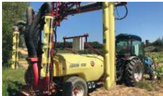
Figura 4. Exemple d'aplicació variable de productes fitosanitaris en conreu de vinya, en funció del mapa de vigor o de sensors en temps real. Imatge: Hardi.
