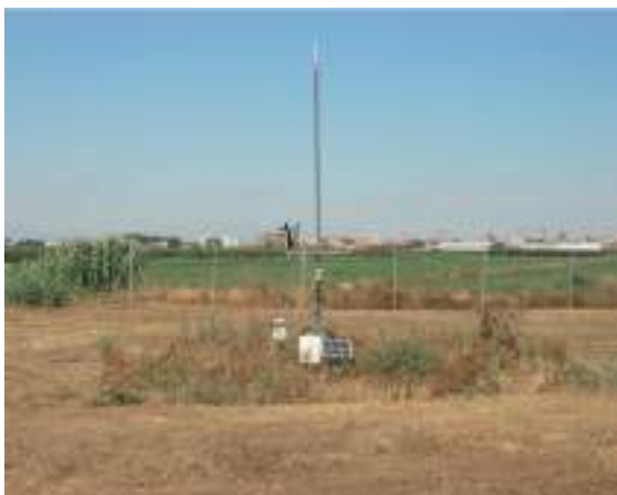
Figura 28. Estació experimental de l'IRTA de Mollerussa (a l'esquerra, estació agrometeorològica; a la dreta, lisímetre de pesada per estimar l'ETc de conreus fruiters).
